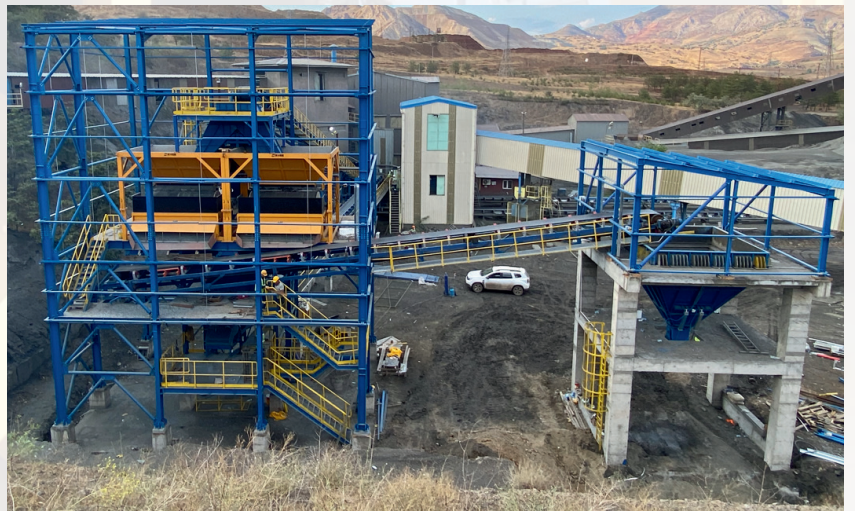
Kuru tambur seperatöre ait saha görüntüsü (Field view of a dry drum separator)
